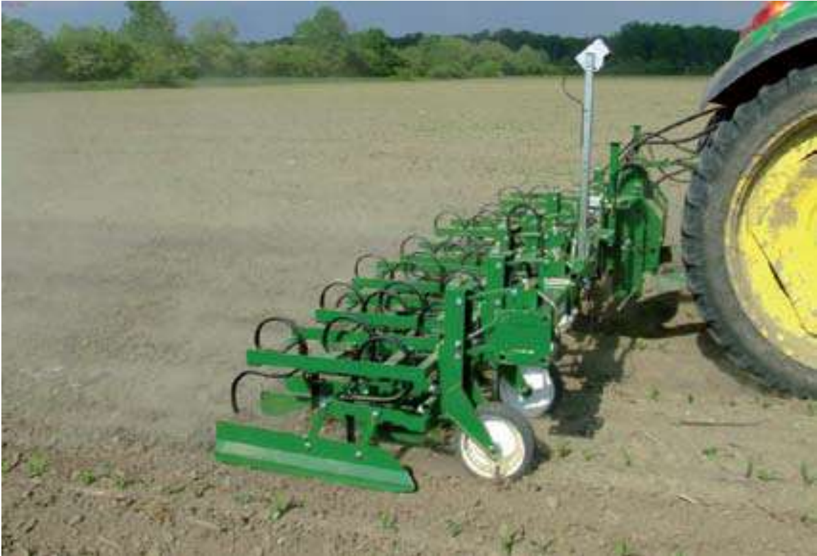
15. ábra: Garford Robocrow sorközművelő kultivátor (forrás: tomelilla.hu).
